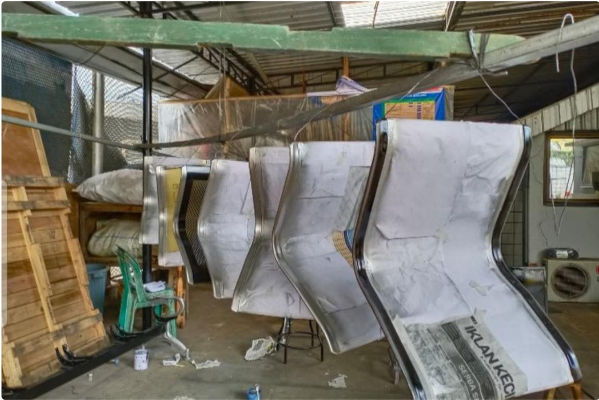
"Perbaikan dilakukan mulai dari pengelasan bagian yang retak, pengamplasan, sampai pengecatan kembali sehingga kursi layanan pendaftaran kunjungan terlihat baru kembali," kata Bima.
